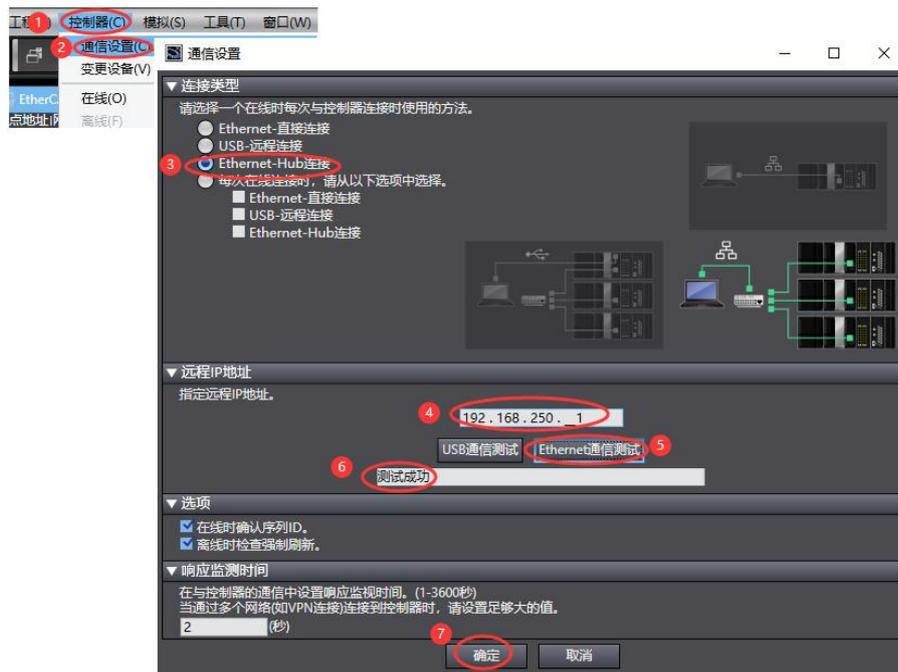
编程电脑与控制器通讯正常后，把控制器进行在线，把 LW 525S-3NL22-ECT 模块扫到 Sysmac Studio 上，如下图所示：
