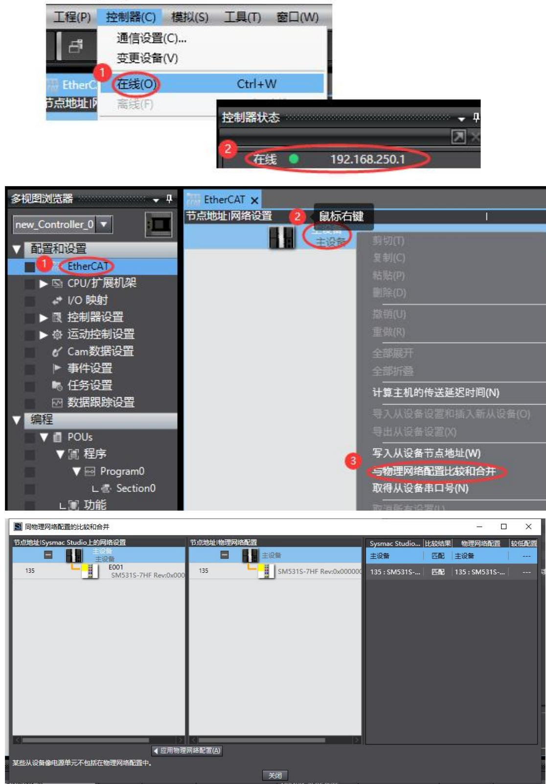
LW 531S-7HF22-ECT 模块成功扫描到 Sysmac Studio 上后，需要把配置下载到控制器中，这样控制器才能对 LW 531S-7HF22-ECT 模块进行监控操作，如下图所示：
