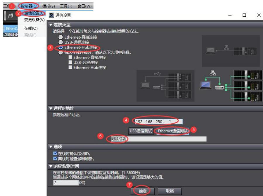
编程电脑与控制器通讯正常后，把控制器进行在线，把 LW 524S-2NL22-ECT 模块扫到 Sysmac Studio 上，如下图所示：
